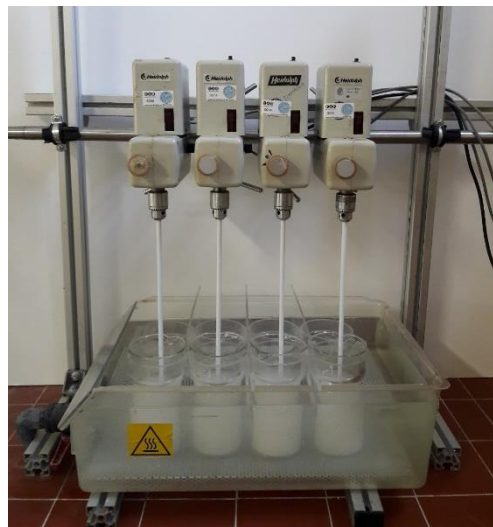
Abbildung 3-2: Vorrichtung zum Kochen der Stärke für die Leimpresse [4]
