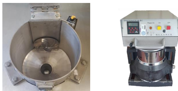
Abbildung 3-1: LC Pulper (links) und Standarddesintegrator (rechts)
