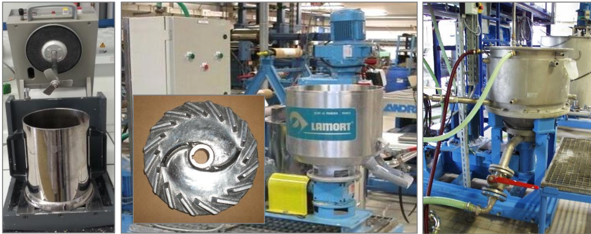
Abbildung 8: Übersicht über die an der PTS verwendeten Pulper. Standarddesintegrator (links), Lamort-Pulper (mitte), PTS-Technikumpulper (rechts).
