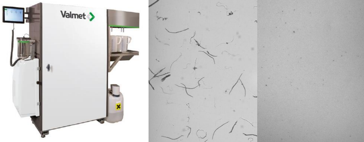
Abbildung 12: Valmet Fractionator (links), Aufnahme der Faserkamera (mitte) und Aufnahme der Ink-Kamera (rechts)
