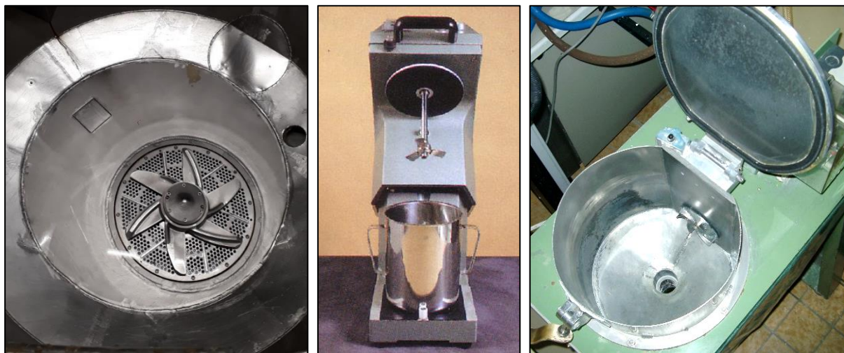
Abbildung 7: Übersicht über die bei Voith und am PMV verwendeten Pulper. Intensa-Pulper (links), Standarddesintegrator (mitte), EcoPaperLoop-Pulper (rechts).
