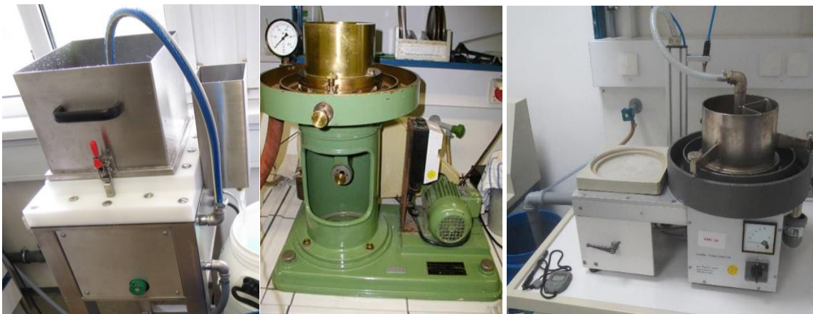
Abbildung 9: Übersicht über die in diesem Projekt verwendeten Sortieraggregate. Somerville (links), Brecht Holl Fraktionator (mitte), Haendl Fraktionator (rechts)
