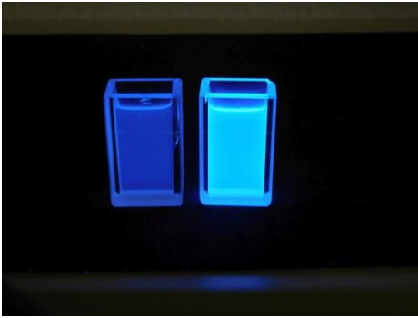
Abb. 2: Fluoreszenz unterschiedlicher Konzentrationen eines optischen Aufhellers in wässriger Lösung (Quelle: www.illumina-chemie.de )
