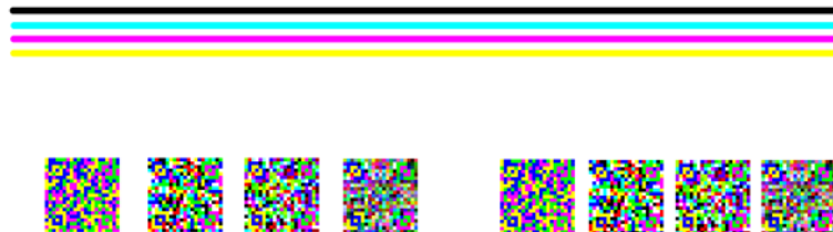
Abbildung 3: Druckform Wischfestigkeit – links ungewischt, rechts gewischt
