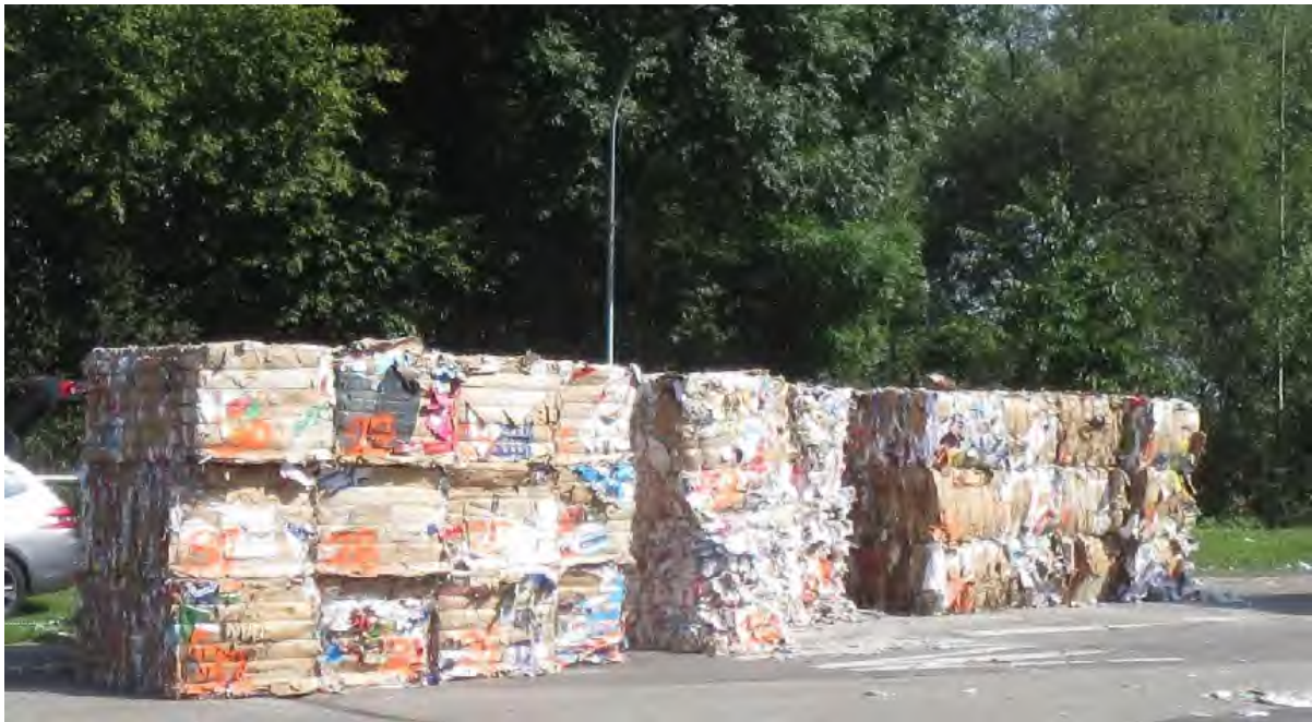
Abbildung 9: Bereitgestellte Ballen-Stapel der synthetischen Altpapierlieferung für die weiteren Untersuchungen mittels emco AP 500 und PaperBaleSensor PBS II (hier Ballenrückseite)
