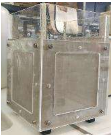
Abbildung 5 Waschzelle und Zentrifuge mit Siebgewebe zur Trennung von Faserstoff in verschiedene Fraktionen
