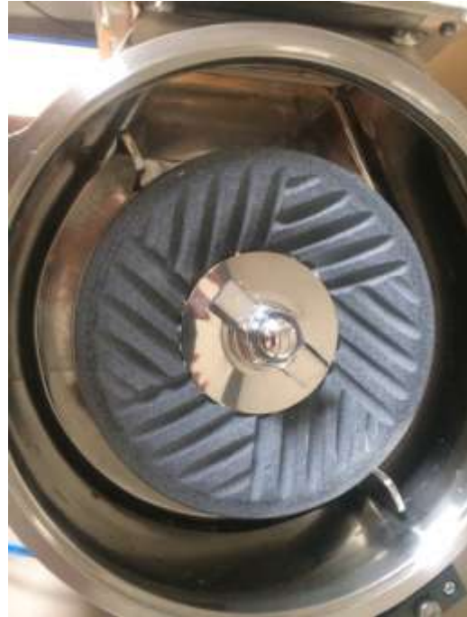
Abbildung 2 Der Supermasscolloider - Gesamtansicht links und Mahlstein rechts
