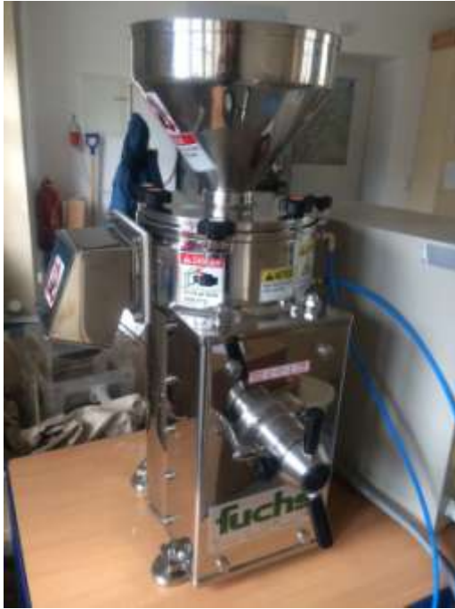
Abbildung 2 Der Supermasscolloider - Gesamtansicht links und Mahlstein rechts
