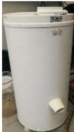
Abbildung 5 Waschzelle und Zentrifuge mit Siebgewebe zur Trennung von Faserstoff in verschiedene Fraktionen
