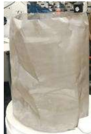
Abbildung 5 Waschzelle und Zentrifuge mit Siebgewebe zur Trennung von Faserstoff in verschiedene Fraktionen
