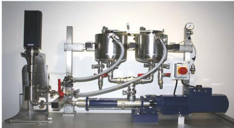
Abb. 8: Labor-Ultraschallanlage mit Ultraschall-Stabsonotrode (links)
