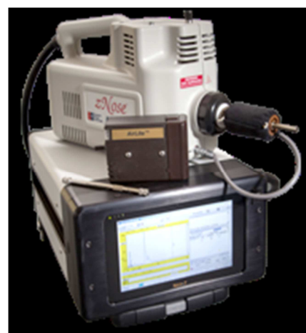
Abb. 17: Tragbarer Gaschromatograph mit SAW-Detektor (Portable zNose in verschiedenen Ausführungen, http://www.estcal.com )
