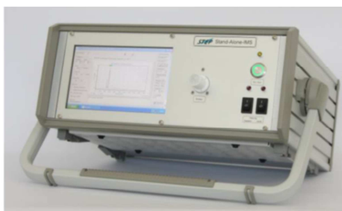
Abb. 19: Beispiele für tragbare Elektronenmobilitätsspektrometer (Kurzbeschreibung: siehe unten)
