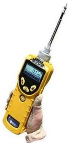
Abb. 25: Tragbares VOC-Handmessgerät mit PID [43] ( www.contrec.ch )
