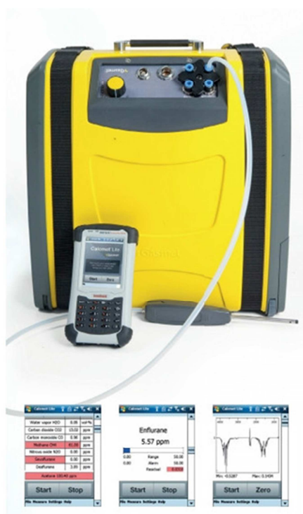
Abb. 23: Tragbarer FTIR-Gasanalysator der Fa. ANSYCO [41].
