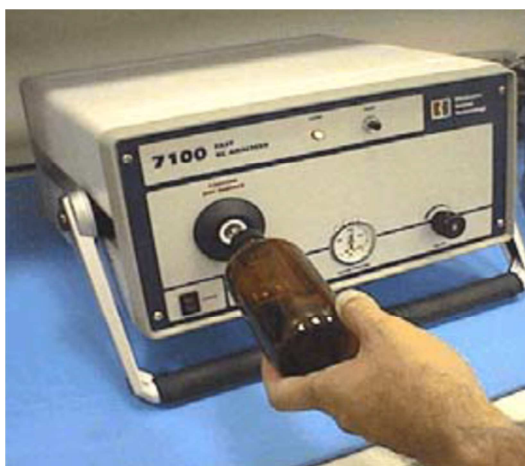
Abb. 17: Tragbarer Gaschromatograph mit SAW-Detektor (Portable zNose in verschiedenen Ausführungen, http://www.estcal.com )
