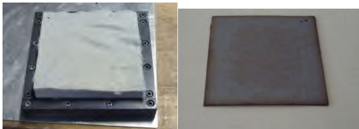
Abbildung 9: Vliesstapel vor und nach thermischer Konsolidierung (Quelle: cetex)
