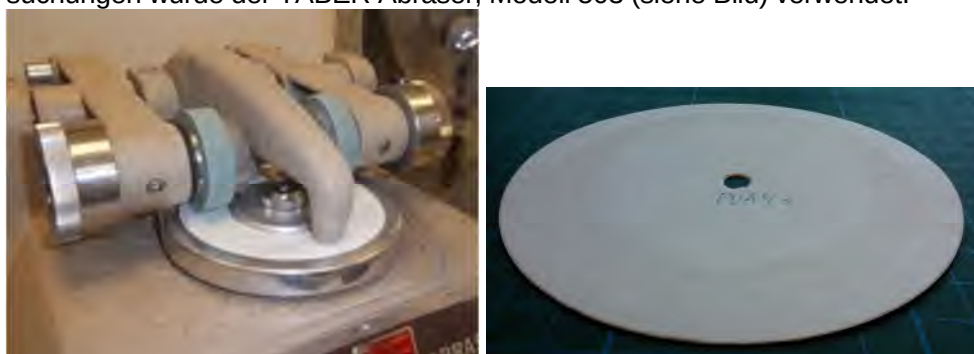
Abbildung 6: Taber Abraser (li), Papiermuster nach Abriebtest (re)
