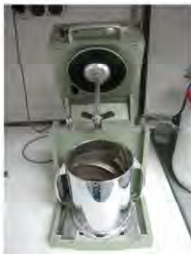
Desintegrieren – hochkonsistent, hohe Scherwirkung
