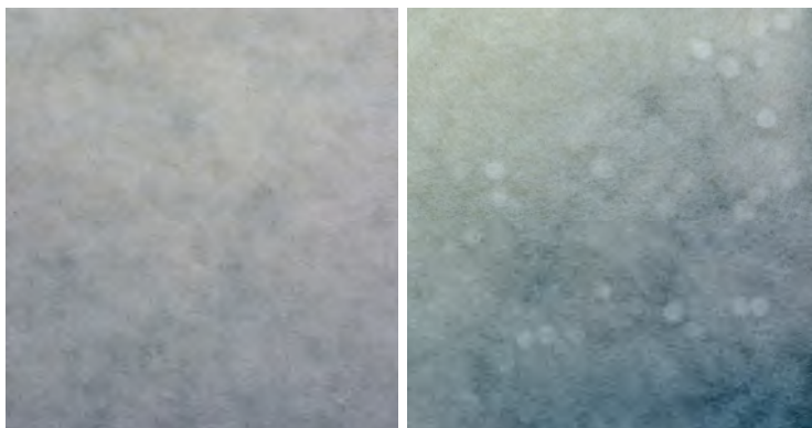
Abbildung 7: Vliesformation mit (re) und ohne (li) PA-6 Verspinnungen
