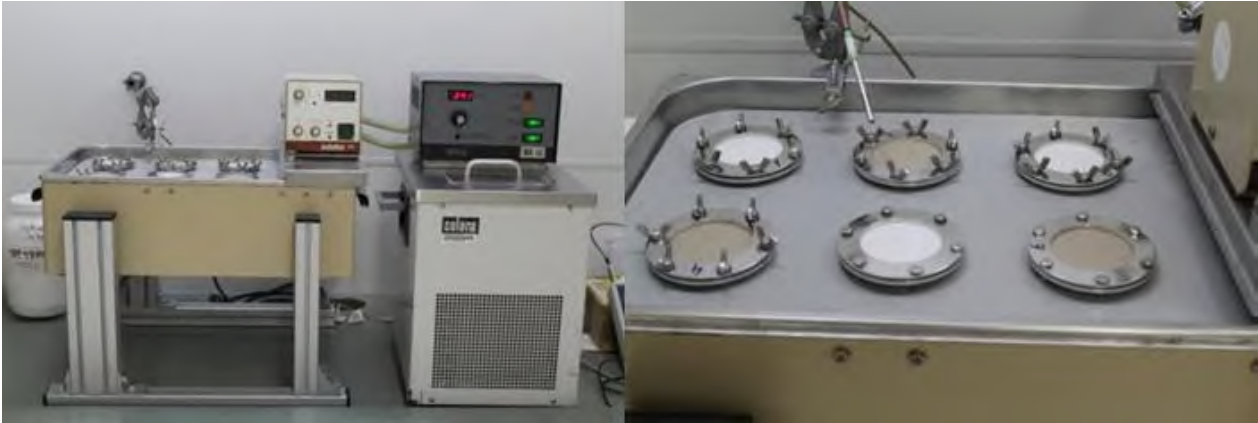
Abbildung 3-24: Aufbau des Hexanpermeationstests, inklusive Wasserbad zur temperierung und Hygrometer zur Bestimmung der relativen Luftfeuchtigkeit.
