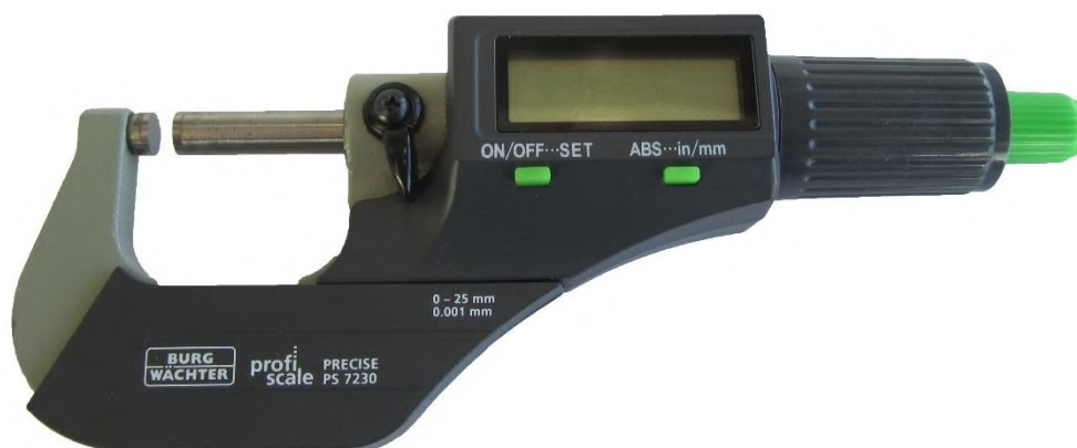
Abbildung 2-37: Die für die Bestimmung der Strichdicken verwendete Mikrometerschraube mit integrierter Drehmomentkontrolle.
