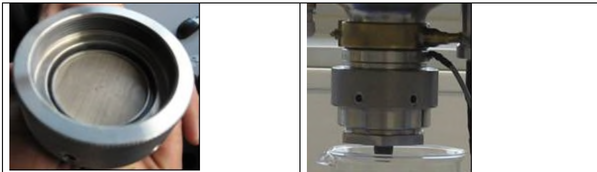
Abbildung 8: Versuchsaufbau FiberXPress mit Mikrowellenwaage zur Pellettrocknung
