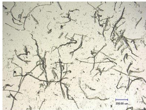
Abbildung 27. Probe mit dem Substitutionsgrad von 0,1 unter dem Lichtmikroskop
