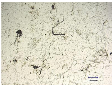
Abbildung 29. Probe mit dem Substitutionsgrad von 2,9 unter dem Lichtmikroskop
