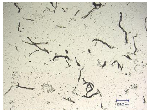
Abbildung 28. Probe mit dem Substitutionsgrad von 1,2 unter dem Lichtmikroskop
