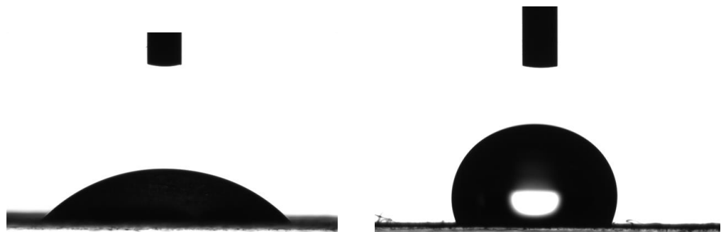
Abbildung 38. Wasserrandwinkel messungen von unmodifizierter Probe (links) und acetylierter Probe (rechts)
