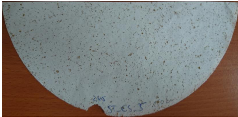
Abbildung 49. Heiß verpresstes Laborblatt aus der Mischung von acetylierten und nicht-acetylierten Fasern (Probe 47)
