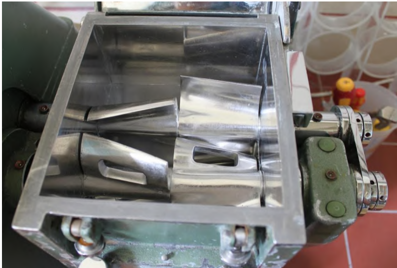
Abbildung 2.2: Knetkammer des Becken Kneters mit ineinander greifenden Schaufeln
