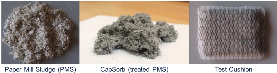
Abbildung 11: Verarbeitungsstufen vom Reststoff zum Absorberkissen [18]
