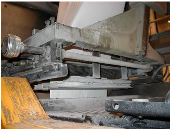
Abb. 2: Staubbedingte Verschmutzung an einem Falztrichter
