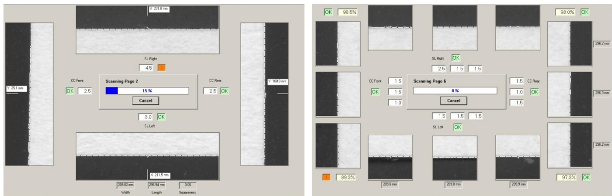
Abb. 26: Bewertung der Schnittkanten für die gesamte Kante (links) und 12-Punkt-Messung (rechts) [17]
