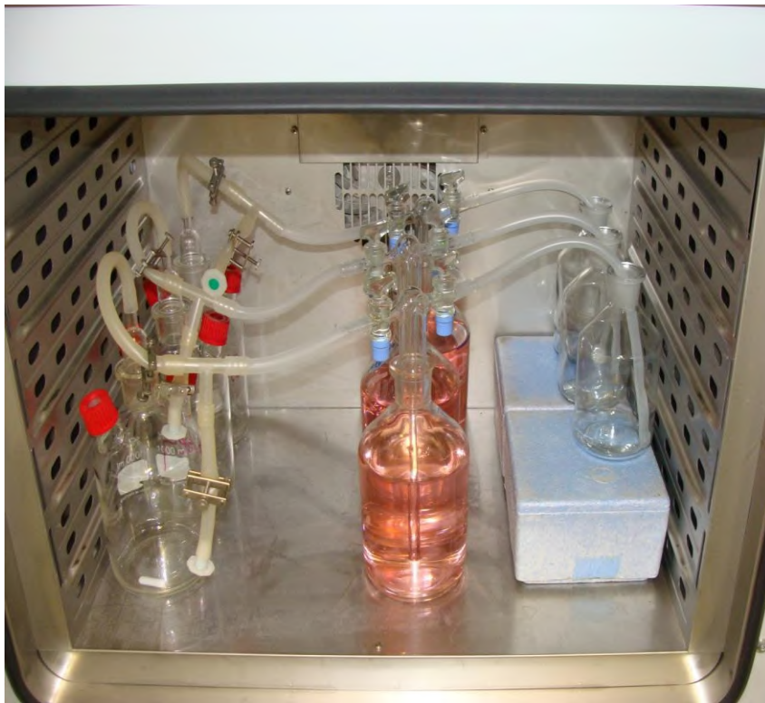
Abbildung 4: Versuchsausrüstung zur Durchführung der Batchtests im Wärmeschrank
