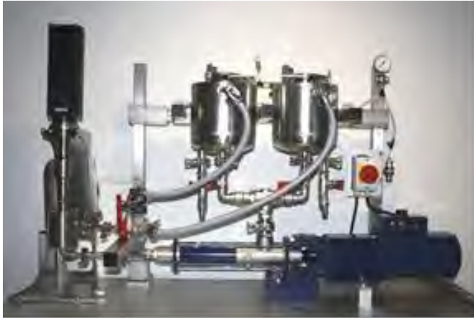
Abbildung 5-3: Ultraschall-Durchfluss-Anlage zur kontinuierlichen Beschallung von Faserstoffsuspension
