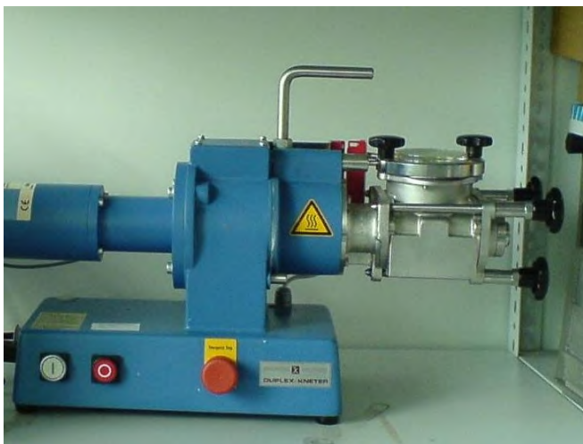
Abbildung 5-4: Versuchsstand zur mechanischen Behandlung im Kneteter
