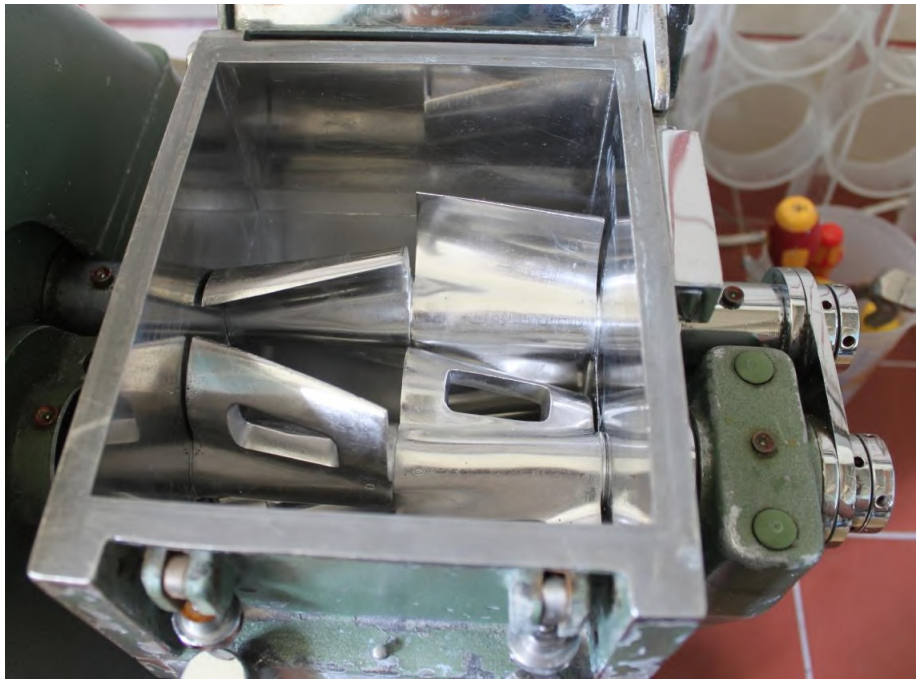
Abbildung 4-2: Knetkammer des Becken Kneters mit ineinander greifenden Schaufeln
