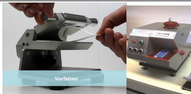
Abb. 2 Vorfalzer und Laborfalzgerät [20]
