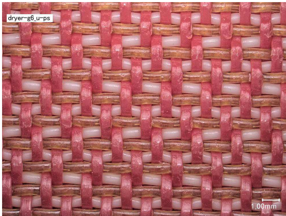
Abbildung 51 Trockensieb Muster „G6_u“ nach Ultraschallentwässerung: Trockensieb auf Sonotrode zugewandte Seite, Papierkontaktseite, lichtmikroskopische Aufnahme mit Keyence VHX-1000 (Messung Heimbach)
