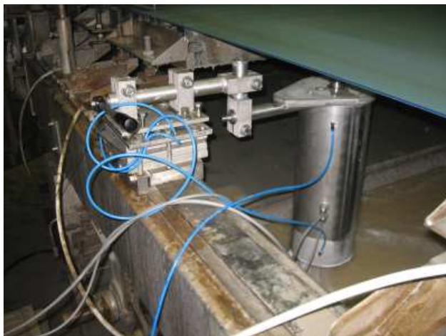
Abbildung 43 Halterung für den Ultraschallwandler mit Sonotrode in Siebpartie
