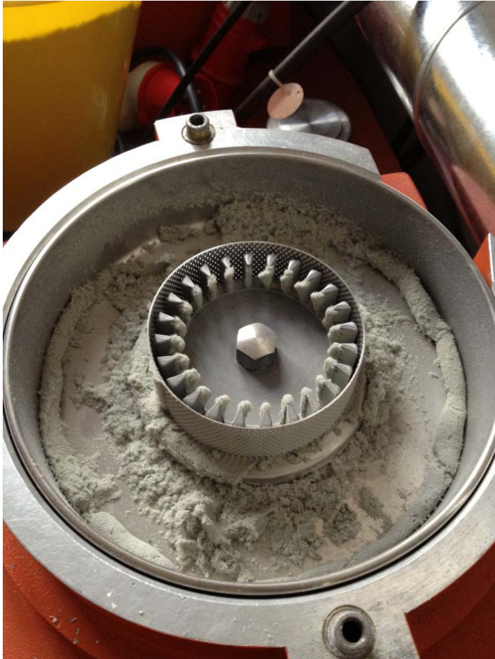
Abb. 55 500 \mu\text{m} Siebring mit 24 Rippen Schlagrotor
