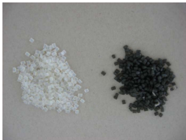
Abb. 49 Polymerteilchen vor (links) und nach dem Deinking
