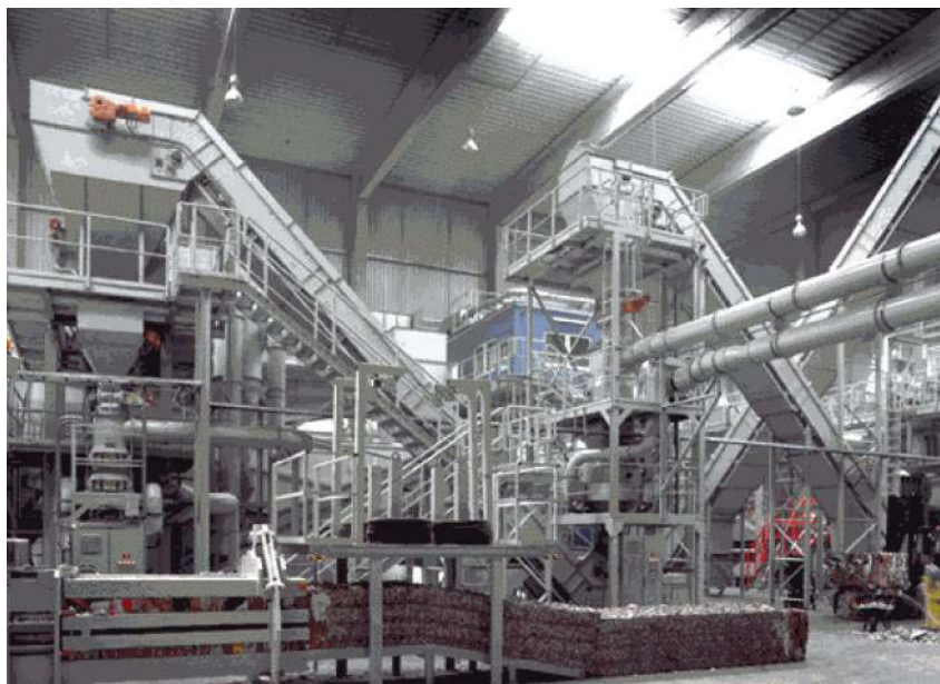
Abb. 29 Aufbereitungsanlage „Trie-Inking“ für die Herstellung von Deinking-Ware, Fa. Trienekens AG (37)
