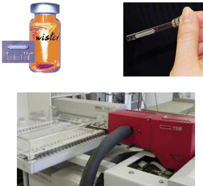
Abb. 2: Gerstel-Twister®, Überführung in ein Thermodesorptionsröhrchen, Analyse der Thermodesorptionsröhrchen mit Hilfe eines GC/MS mit Autosampler (Quelle: Homepage Fa. Gerstel GmbH & Co. KG, Mellinghofen)
