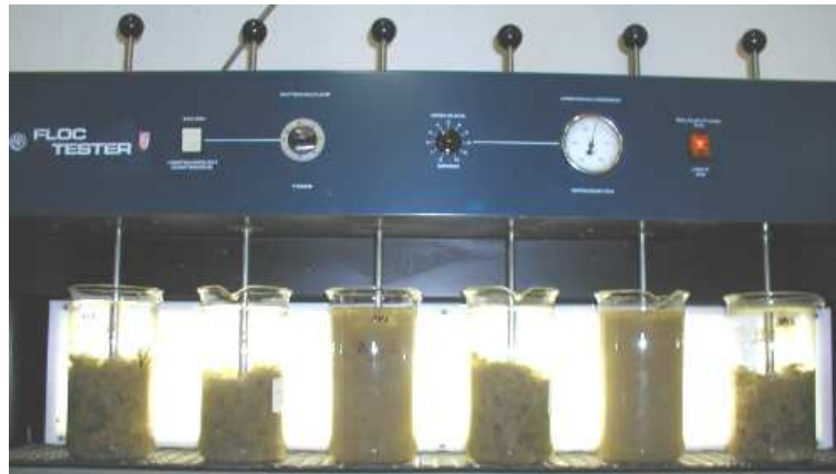
Abbildung 5 Flockungstester zur Bewertung der Flockung der Faserstoffsuspension bei Dosierung von Additiven
