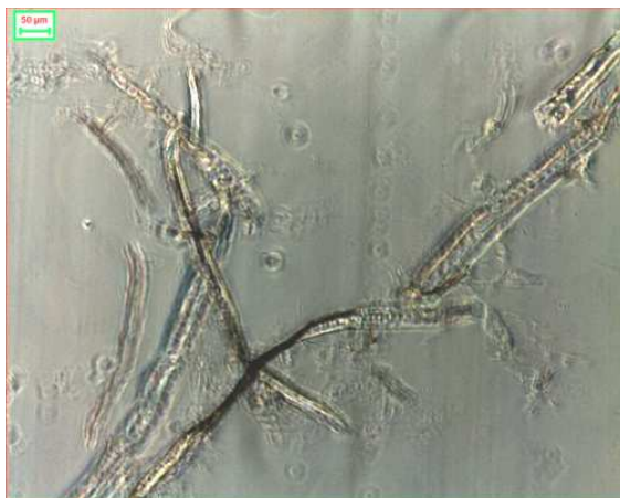
Abbildungung 30 Lichtmikroskopische Aufnahme von gemahlenem (200 kWh/t, 3 J/m) Kiefern-Sulfatzellstoff ohne US-Behandlung
