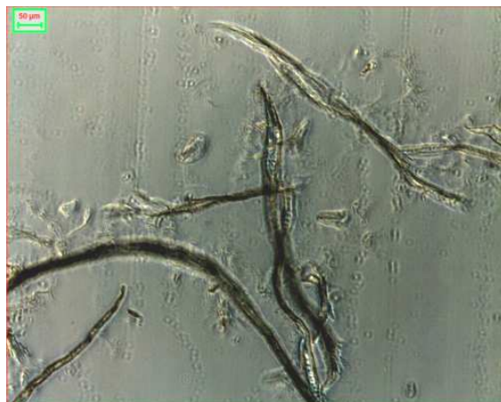
Abbildungung 31 Lichtmikroskopische Aufnahme von gemahlenem (200 kWh/t, 3 J/m) Kiefern-Sulfatzellstoff und anschließender US-Beh. (UB) (300 kWh/t, 68 µm, 1 bar, SD 1 %)
