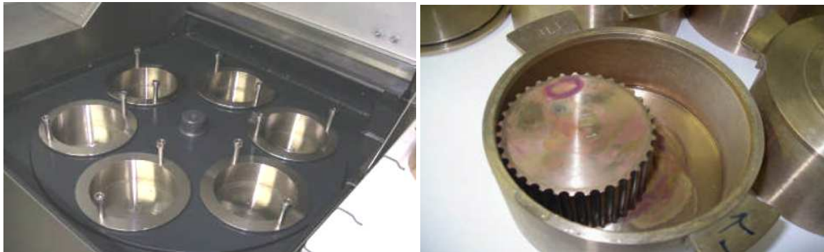
Abbildung 9 JOKRO-Mühle an der Forschungsstelle zur Mahlung von Faserstoffsuspension im Labormaßstab – Karussell für Mahlbüchsen (links), Mahlbüchse mit Mahlkörper (rechts)
