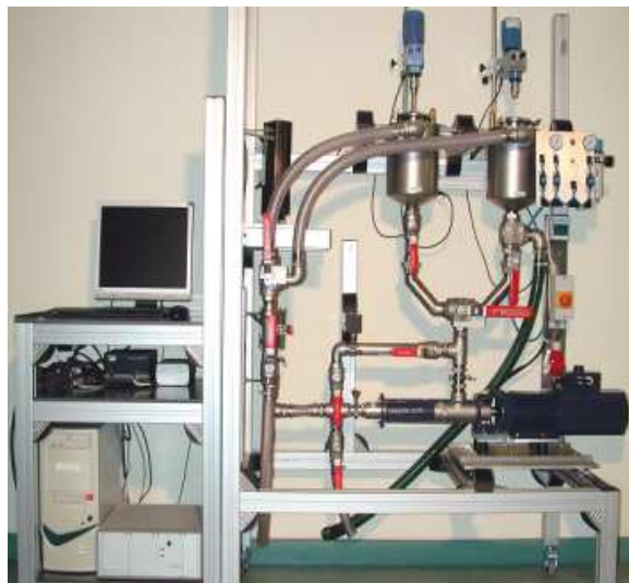
Abbildung 6 Ultraschall-Durchfluss-Anlage zur kontinuierlichen Beschallung von Faserstoffsuspension
