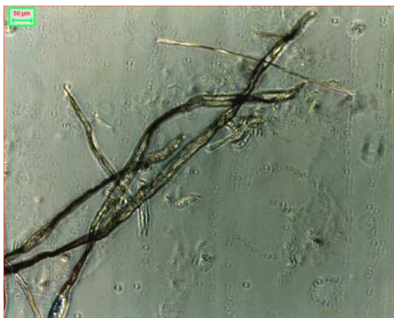
Abbildungung 28 Lichtmikroskopische Aufnahme von gemahlenem (50 kWh/t, 1 J/m) Kiefern-Sulfatzellstoff ohne US-Behandlung
