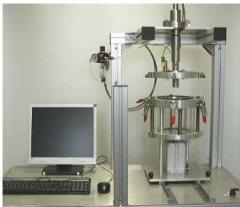
Abbildung 4 Ultraschall-Batchzelle zur diskontinuierlichen Beschallung von Faserstoffsuspension
