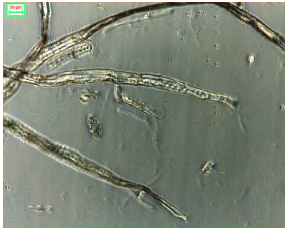
Abbildungung 27 Lichtmikroskopische Aufnahme von ungemahlenem Kiefern-Sulfatzellstoff
