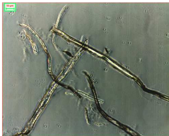
Abbildungung 29 Lichtmikroskopische Aufnahme von gemahlenem (50 kWh/t, 1 J/m) Kiefern-Sulfatzellstoff und anschließender US-Behandlung (UB) (300 kWh/t, 68 µm, 1 bar, SD 1 %)
