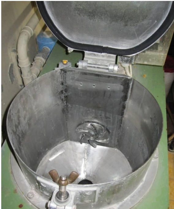
Abbildung 3: Niederkonsistenz-Laborpulper des PMV
