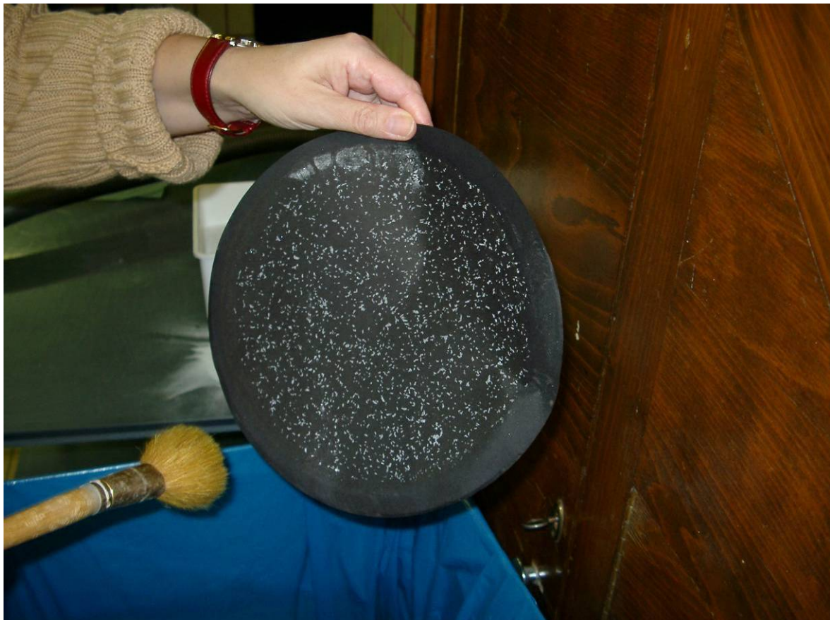
Abbildung 5.3-6: Abpinseln von Korundpulver nach der INGEDE-Methode
