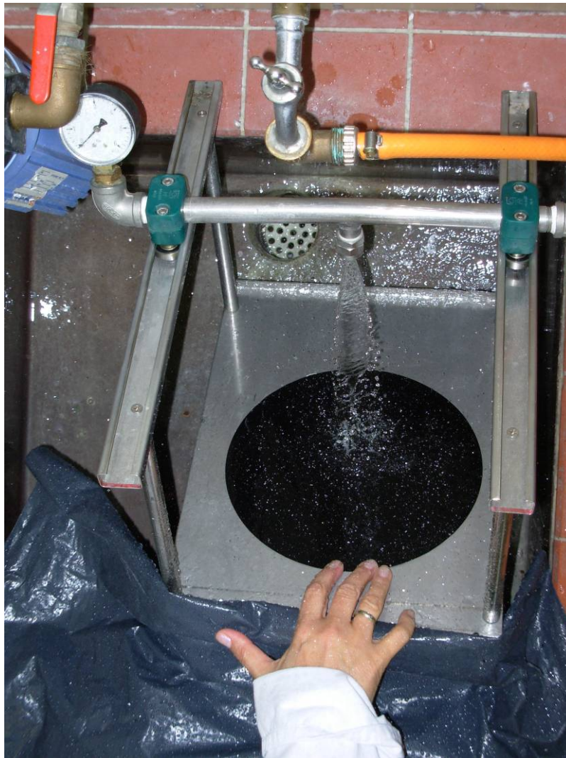
Abbildung 4.6-1: Waschvorrichtung der TAPPI-Methode (Wasserstrahl hat nicht den erforderlichen Betriebsdruck)
