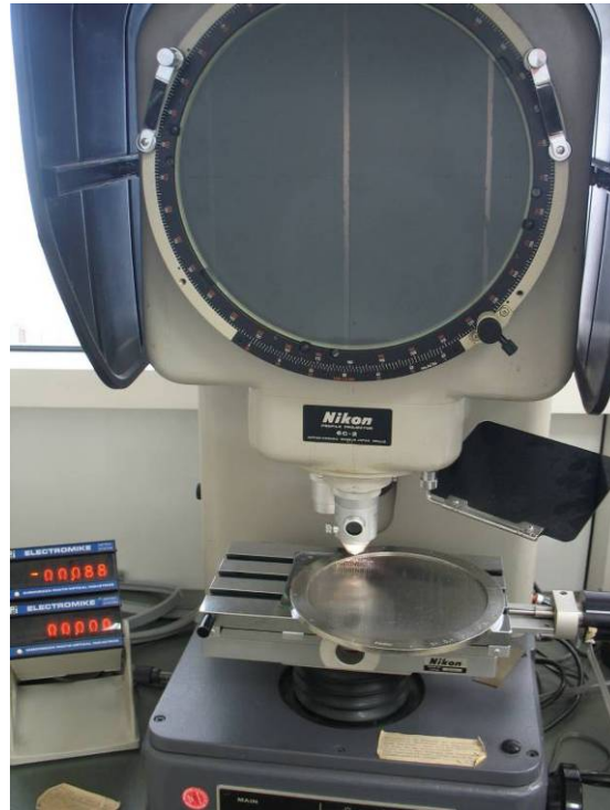
Abbildung 4.5-1: Nikon Profil-Projektor zur Vermessung der Schlitzweite bei Durchlicht (mittig ist auf dem Bildschirm ein Schlitz der aufliegenden Platte zu erkennen, links daneben, die digitale Messanzeige)
