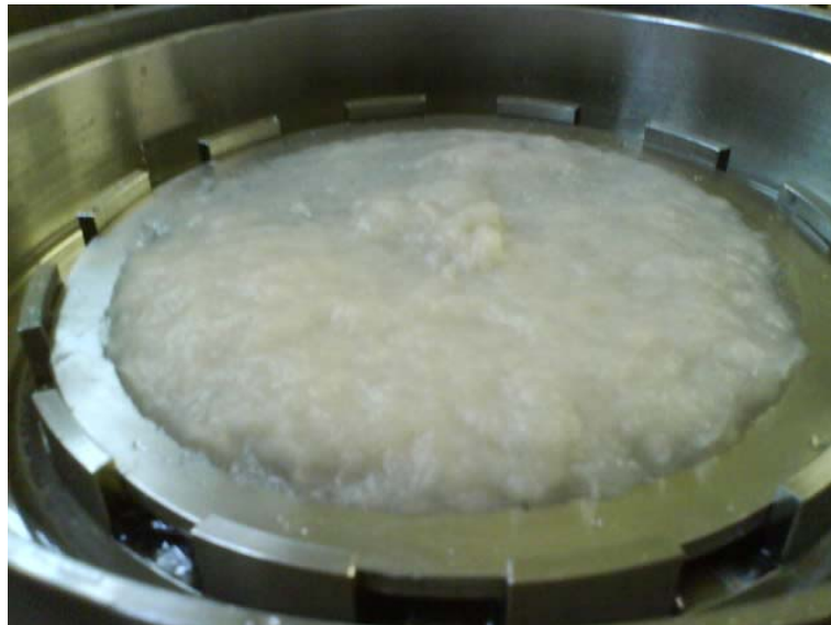
Abbildung 5.4-1: Sortierrückstand von 50 g otro grafischem Altpapierstoff unter Verwendung einer 100 µm Laser geschnittenen Schlitzplatte
