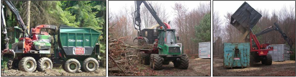
Abbildung 2: Hacker mit hackereigenem Aufsattelcontainer, Einsatz auf der Rückegasse (links) oder an der Waldstraße (Mitte) und beim Überkippen der Hackschnitzel (rechts)
