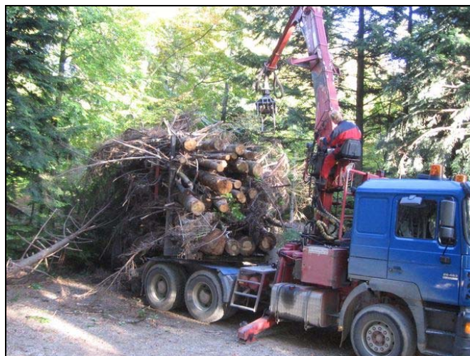
Abbildung 1: Zwischentransport von Energieholz auf einen zentralen Hackplatz mit einem Langholz-LKW mit eingelegter Wechselbrücke
