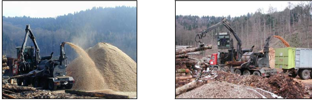
Abbildung 4: Hacken an einem zentralen Platz auf einen Haufen (links) bzw. in einen landwirtschaftlichen Anhänger (rechts) (Fotos: CREMER, 2006; TEXTOR, 2005)
