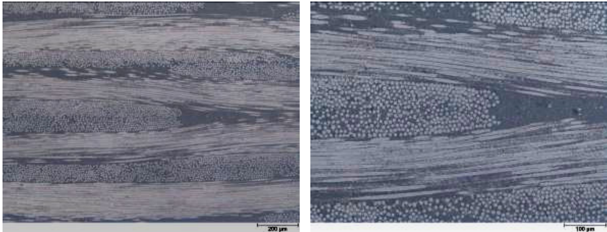
Abbildung 8 - 6: Aufsicht auf die MD-ZD-Ebene des Belags A (gelb) Base-Layer in 50- bzw. 100-facher Vergrößerung.
