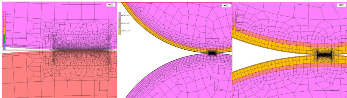
Abbildung 4 - 47: Detailansicht Hartnip mit Papierbahn (links) sowie Soft- (mitte) und Wechselnip (rechts) ohne Papierbahn.
