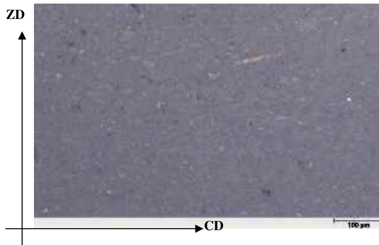
Abbildung 8 - 4: Aufsicht auf die CD-ZD-Ebene des Belags A (gelb) Function-Layer.
