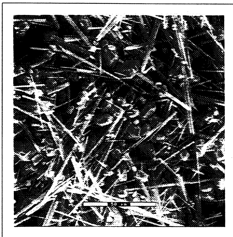
Bild 2: Elektronenmikroskopische Aufnahme der mit magnetbehandeltem Leitungswasser erhaltenen Kalkausfällungen (Härtegrad: 60°dH, Temperatur: 80 °C)
